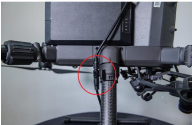
4、将控制盒的数据线与M300连接好，开启飞机，检查控制盒顶部状态灯的显示状态，如果一开机显示红灯亮，说明OSDK接口供电正常。下一步开启M300 RTK OSDK功能。
