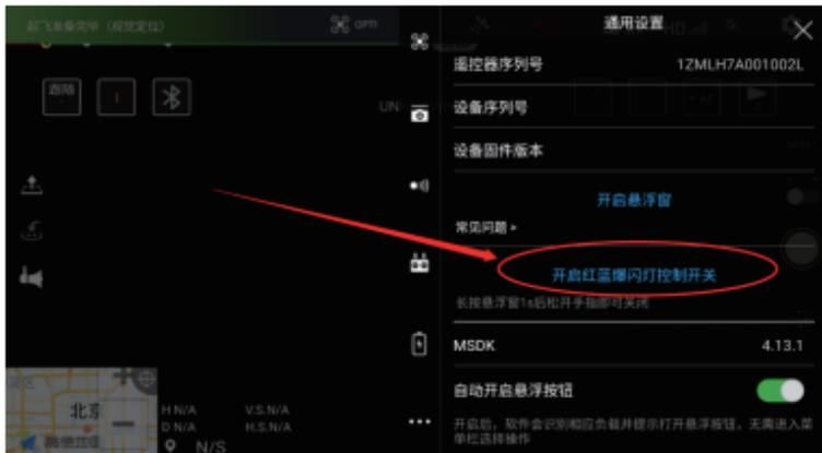
第四步：在弹出“是否同时开启DJI Pilot”的提示框后，点击确认按钮，界面切到DJI POLIT APP主界面，同时显示红蓝爆闪灯的控制按钮，灯未开启时，控制按钮显示为白色，此时，可以通过DJI POLIT APP控制无人机的飞行，用悬浮按钮控制灯开关。
