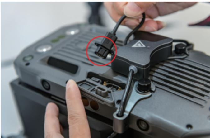
3、安装红蓝爆闪灯在M300脚架，并将灯线与控制盒相连，安装位置及方向如图
