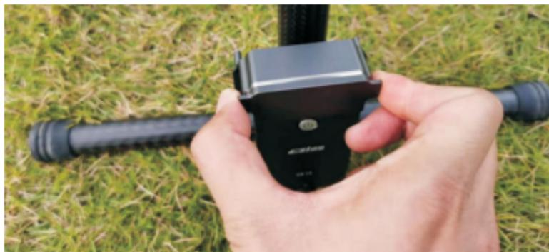
2.2 把电池放进电池仓，然后先按压电池右端，再按压电池左端，听到“咔”的一声，表明电池安装到位。请注意，电池仓的左边是正极，右边是负极。
