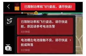
答:以上均为正常情况,可以继续飞行,使用 TK3 给飞机供电都会出现这个警报。 出现这种警报是因为无人机处于 TK3 工作状态下, 优先 TK3 供电, 当 TK3 供 电能满足无人机功耗时, 电池没有功率输出, 电池没有功率输出, 就会激发飞机报警, 对飞行安全没有影响。
